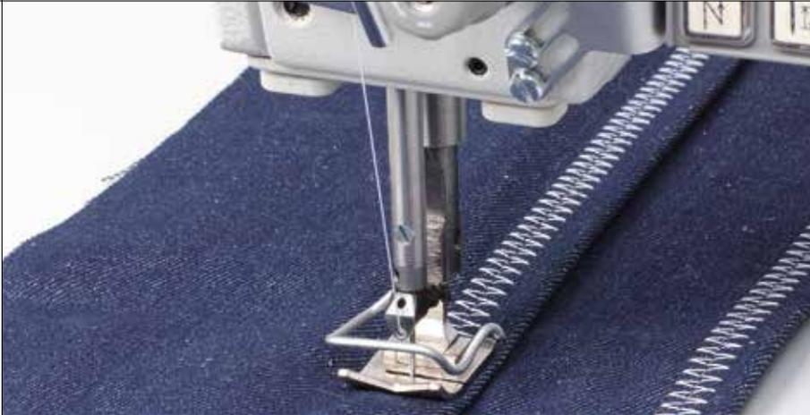
**Klasse 525i:** Leichtes Nähen verschiedener Arten von Textilien und leichten Ledermaterialien. Die Maschinen sind mit einem großen Greifer ausgerüstet, maximale Überstichbreite von 10 mm (in Abhängigkeit der verbauten Steuerkurve).
