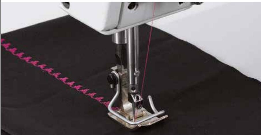
**Klasse 525i:** Verschiedene Muster, auch als Doppelnaht, können aufgrund der leicht austauschbaren Steuerkurven gefertigt werden.
