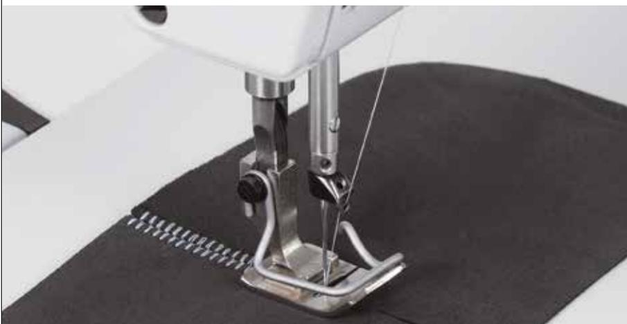
**Klasse 525i:** Die Maschine kann in der Schuhindustrie, zusammen mit Musterkurve S080 674113, für Zickzack-Rückennähte verwendet werden. Es besteht hierbei kein Bedarf für ein Verstärkungsband.
