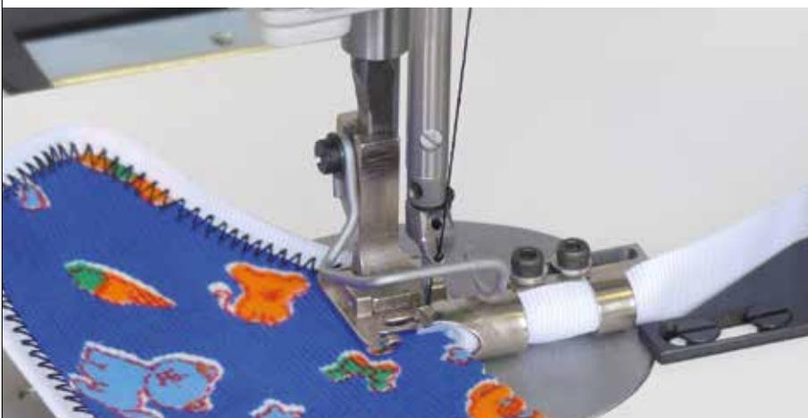
**Klasse 525i:** Maschine ausgestattet mit Näheinrichtung S980 000312 für Einfassarbeiten. Die Einfasser werden kundenspezifisch ausgewählt.
