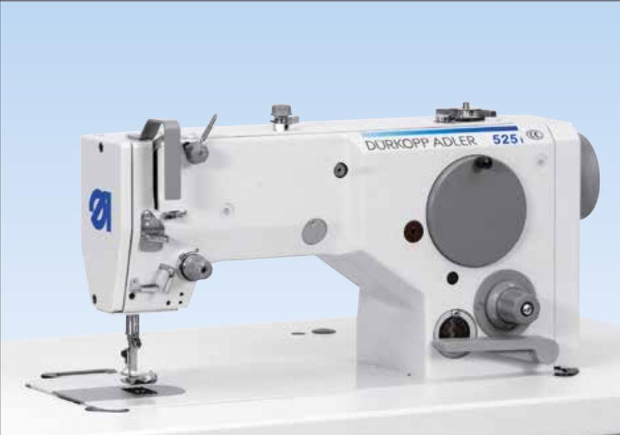
**Klasse 525i-811:** Einnadel-Steppstich Zickzackmaschine für Ziersteperei mit Untertransport, manueller Verriegelung, großem Greifer, max. Überstichbreite von 10 mm, max. Stichlänge von 5 mm, Nadelstärke Nm 80–110, Nähfußlüftung max. 12 mm.
