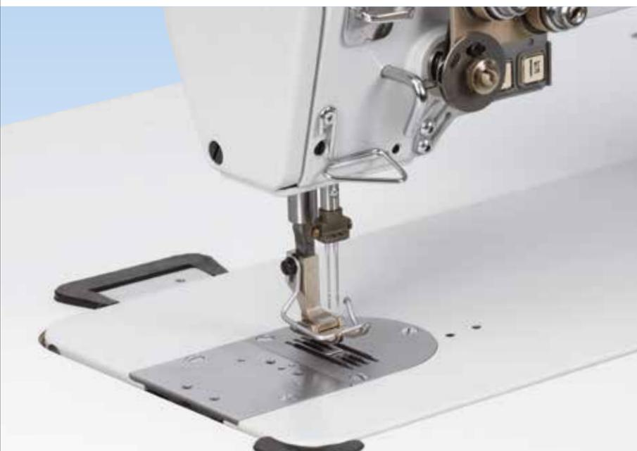
**Klasse 525i:** Mit Hilfe des Zweinadel-Bausatzes (Nr. S791 630003), können alle lieferbaren Muster auch als Doppelnah ausgeführt werden. Die Einrichtung beinhaltet Nadelhalter für Nahtbreiten von 3, 4 und 5 mm.
